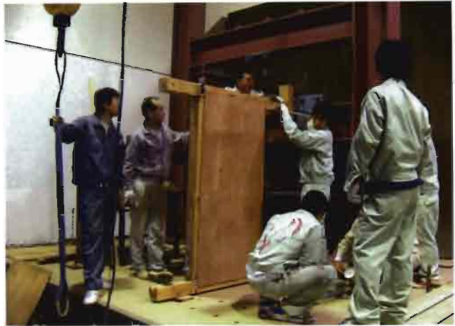
木造軸組実物大実験(構造実習)
